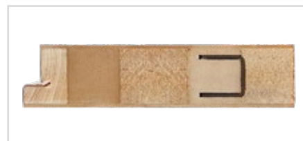
křídlo 46 mm zesílené masivním ocelovým U profilem
